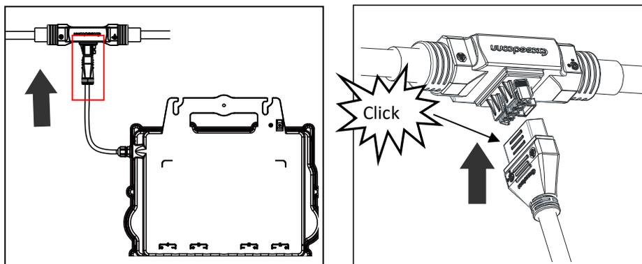
Interface do conector AC da esquerda para a direita.
