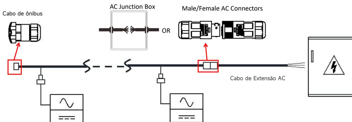
Quando é necessário um cabo de extensão AC, os usuários podem conectar o cabo de bus AC e o cabo de extensão AC em uma caixa de junção ou usar um par de conectores AC macho/fêmea que a APsystems fornece como accessory opcional.
