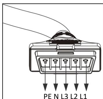
Cubra todos os conectores não usados com T-CONN CAP para proteger os conectores não usados.
