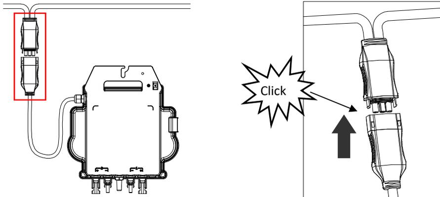
Melhor prática: Use a ferramenta de desbloqueio do cabo AC Bus para desconectar os conectores.
