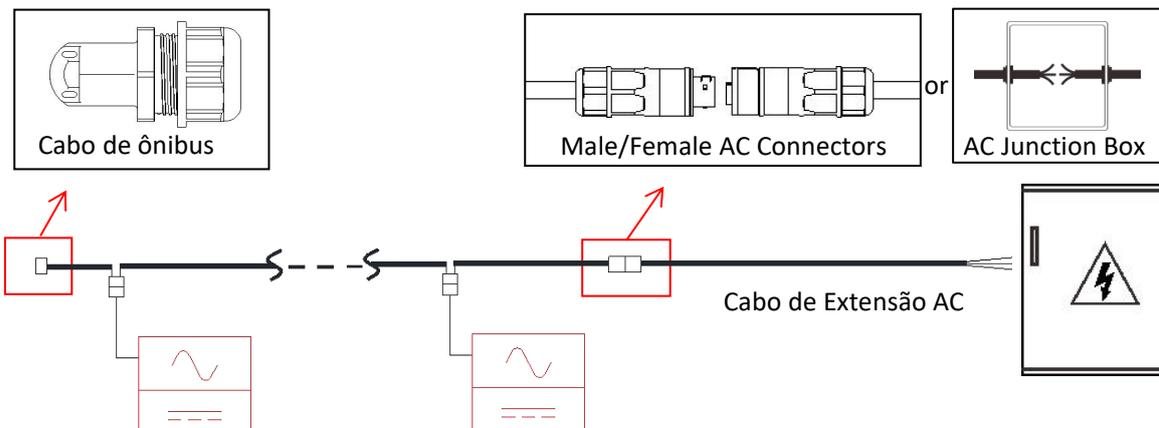
Quando é necessário um cabo de extensão AC, os usuários podem conectar o cabo de bus AC e o cabo de extensão AC em uma caixa de junção ou usar um par de conectores AC macho/fêmea que a APsystems fornece como accessory opcional.
