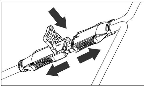
Interface do conector AC da esquerda para a direita.
